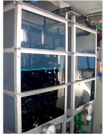
La celda Alfa de la planta, el sistema de tuberías y, arriba, los tanques con la solución de vanadio-plata.
